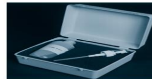
Alat uji Carbonasi beton dengan larutan Indikator pH phenolphthalein
