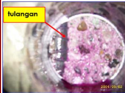
Areal beton di sekitar tulangan belum terkarbonasi (warna merah muda)
