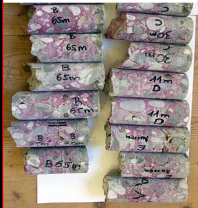
Areal beton di sekitar tulangan belum terkarbonasi (warna merah muda)
