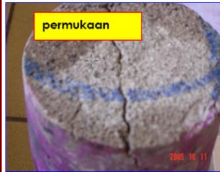
Permukaan beton telah terkarbonasi (tidak berwarna/transparan)
